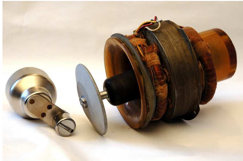
Tube à rayons X CGR sans sa verrerie type HD234-2-N 1954 à 1990 stator, rotor, anode et cathode
